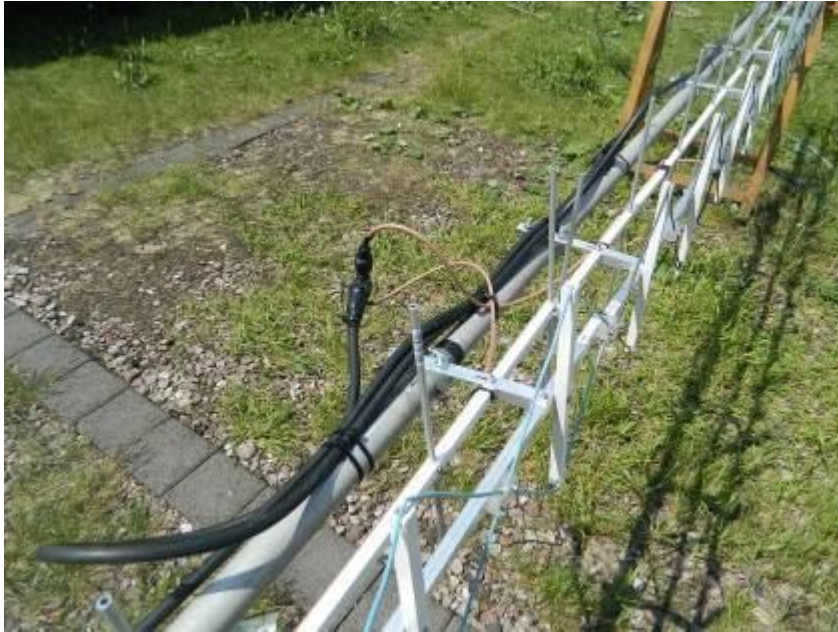
16-Element-Gruppenstrahler sorgte für einen breiten Öffnungswinkel bei hohem Gewinn
