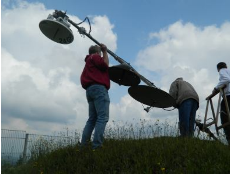
Frank, DL2ALF, Harti, DL6AUI und Jens, DL2AKT am Mast mit den Spiegeln für 6, 3 und 1,2 cm
