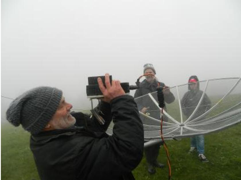
Der Spiegel für 13 cm wird montiert, ein letzter prüfender Blick an Vorverstärker und PA.
